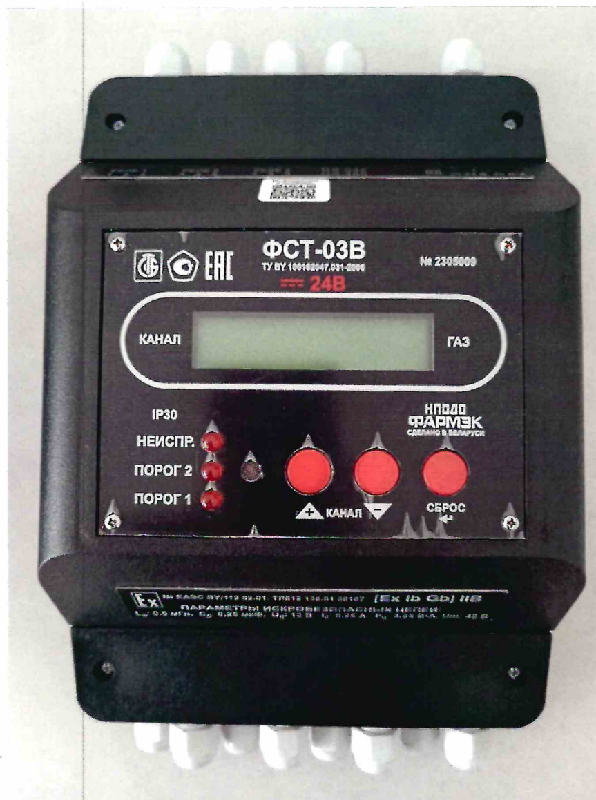
Рисунок 1.2 – Фотография общего вида и маркировки блока питания и сигнализации газоанализаторов ФСТ-03В с напряжением питания 24 В (изображение носит иллюстративный характер)
