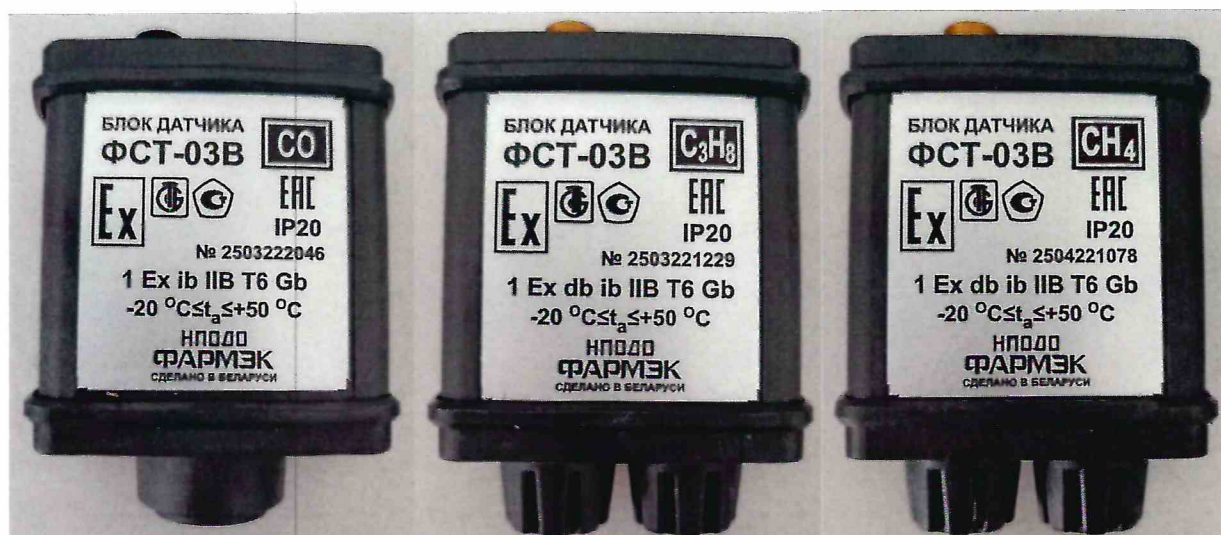
Рисунок 1.3 – Фотографии общего вида и маркировки блоков датчиков газоанализаторов ФСТ-03В (изображение носит иллюстративный характер)
