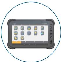
RTK-планшет для точной GPS/ГЛОНАСС - привязки пройденного маршрута и эффективно работает с трассоискателем. RTK-планшет разработан для полевого сбора геоанных с точностью позиционирования до нескольких сантиметров.
