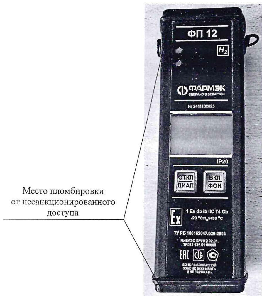
Рисунок 3.1 – Схема пломбировки от несанкционированного доступа
