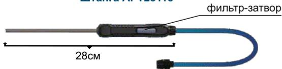
Штанга АРТ23113 предназначена для отбора проб контролируемой среды при наземном применении. Конструктивно штанга состоит из пробоотборной трубки, ручки со встроенным фильтром и трубки полиуретановой (L=1 м).
