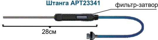
Штанга АРТ23341 предназначена для отбора проб контролируемой среды при наземном применении. Конструктивно штанга состоит из пробоотборной трубки, ручки со встроенным фильтром, трубки полиуретановой (L=1 м) и соединителя для подключения к газоанализатору.
