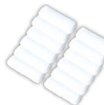
Пылевой фильтр находится в газозаборном тракте портативных приборов со встроенным микронасосом. Фильтр предназначен для предотвращения попадания пыли в газозаборный тракт. Замена фильтра требуется по мере загрязнения, но не реже 1 раза в месяц.
