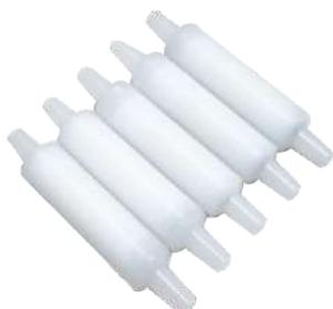
Фильтр-затвор предназначен для предотвращения попадания воды в газозаборный тракт приборов. В процессе эксплуатации необходимо следить за состоянием фильтра. При попадании воды и других жидкостей, вещество, находящееся в капсуле, изменяет окраску с белого на **розовый** или **красный** цвет, что свидетельствует о перекрытии газозаборного тракта.
